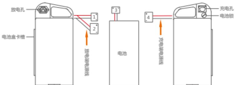
注：首先将电池盒放电孔端1号电源线与电池盒充电孔端4号电源线连接（正极连接正极，负极连接负极），然后将电池盒放电孔端2号电源线和电池3号电源线连接（正极连接正极，负极连接负极）。
